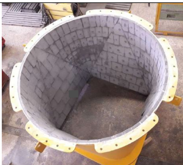
RIVESTIMENTO INTERNO TRAMOGGIA
