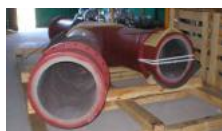
Tubazioni rivestite internamente con cilindri in basalto
