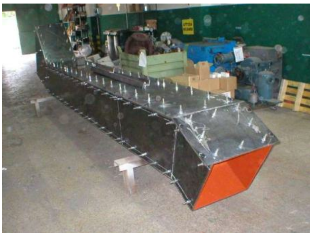
Particolare rivestimento in poliuretano antiacido.
