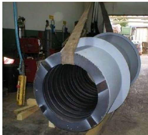
Condotta per altoforno con corazzatura interna.
