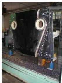
Manufatti in carpenteria con rivestimento in gomma poliuretanaica
