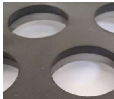
Foro conico superiore antintasante sul rivestimento in gomma poliuretanica vulcanizzata a caldo
