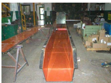
Manufatti in carpenteria con rivestimento in poliuretano
