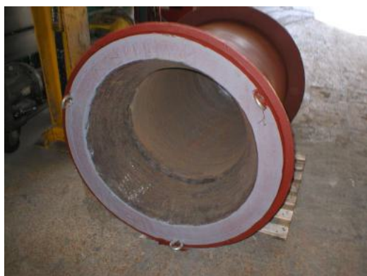
Condotto cilindrico corazzato Per altoforno.
