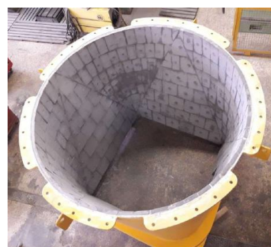
Manufatti in carpenteria con rivestimento in basalto
