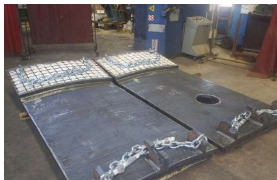
Piastre blindatura per sbattimento loppa impianto INBA.
