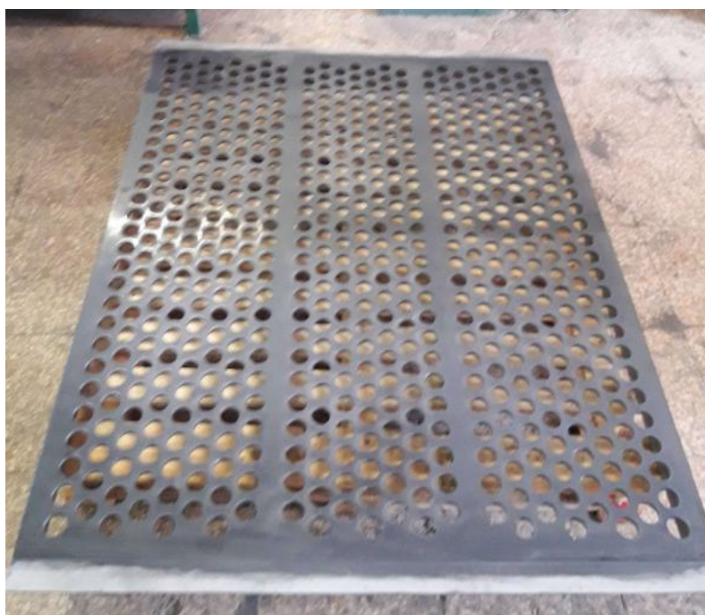
Lamiera vagliante in gomma poliuretanica antiacida ed antiusura per vagliatura coke
