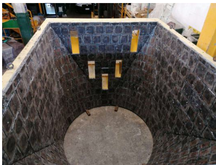
PARTICOLARE RIVESTIMENTO INTERNO TRAMOGGIA SUPERIORE
