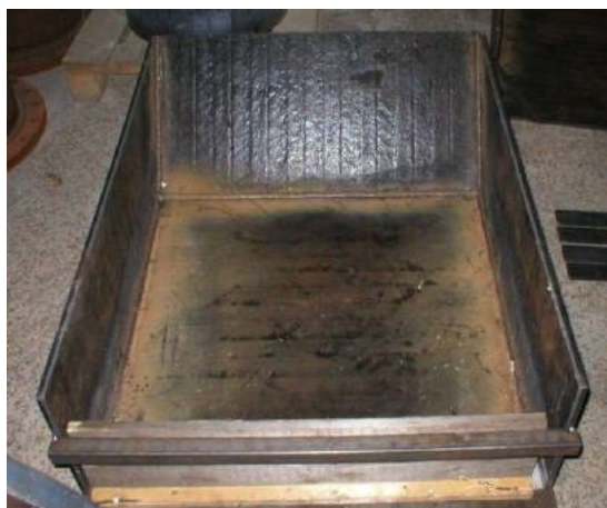
Alimentatore corazzato con riporto antiusura con alto contenuto di Cr.
