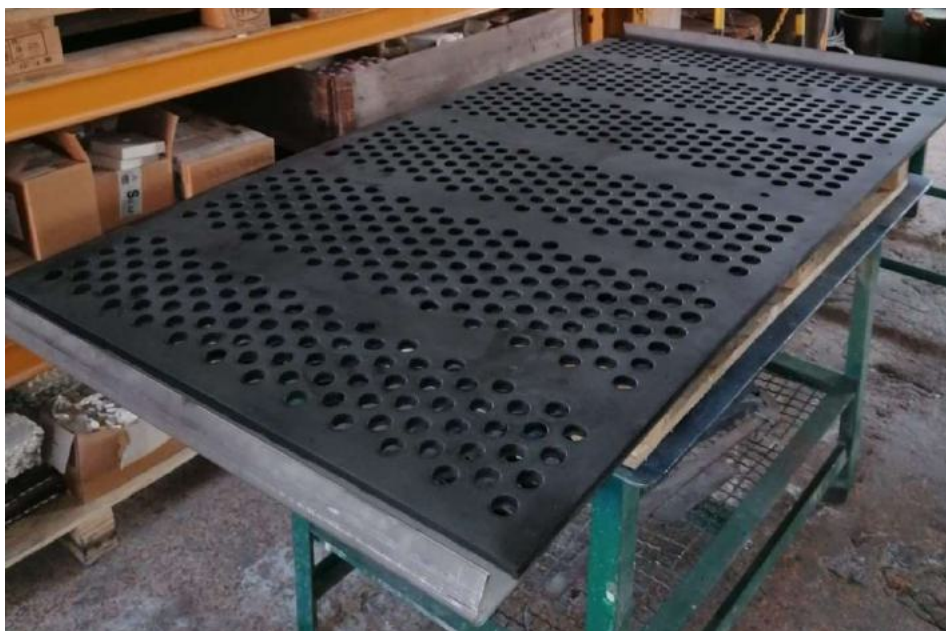
Lamiera vagliante rivestita in gomma poliuretanic antiacida ed antiusura per vagliatura calcare e dolomite.
