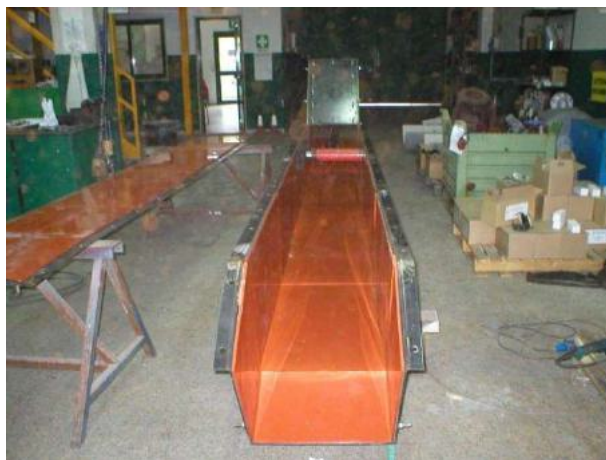
Particolare rivestimento in poliuretano antiacido.
