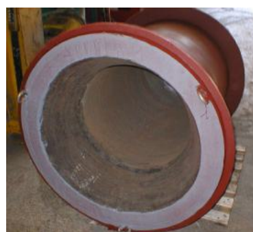
Manufatti in carpenteria con riporti in acciaio duro 50-60 HRC
