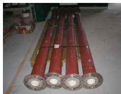
Tubazioni rivestite internamente con cilindri in ceramica Al_2O_3 92%
