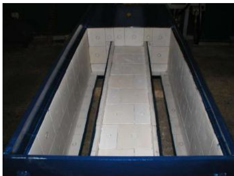
Manufatti in carpenteria con rivestimento in ceramica Al_2O_3 92%
