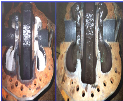
FASE: 3 APPLICAZIONE PASTA MOLECOLARE (PLASTICA)
